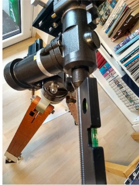
4. Die Deklinationsachse mit der Wasserwaage in Zenitstellung ausrichten (Blickrichtung des Teleskops = 90 Grad senkrecht zum Horizont).
