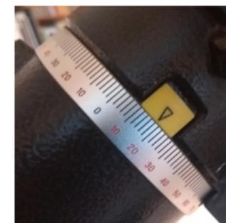
Mit Hilfe der Azimutschrauben wird nun die Sonne im Blickfeld zentriert (Schutzmaßnahmen für die Sonnenbeobachtung nicht vergessen). Sind die Teilkreise einmal gut geeicht und werden wie die Polhöhe nicht mehr verändert, ist eine Poljustage mit Hilfe des Stundenwinkels in einer Minute erledigt.
