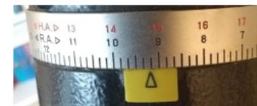
Die Stundenachse (oben) wird nun so gedreht, dass der Stundenwinkel (rote Skala) den Wert 2h 50m bzw. 14h 50m anzeigt. Ob 2h oder 14h ist davon abhängig, ob sich das Teleskop auf der West- oder Ostseite des Meridians der Montierung befindet; die Deklinationsachse entsprechend auf  $-18^\circ$ .
