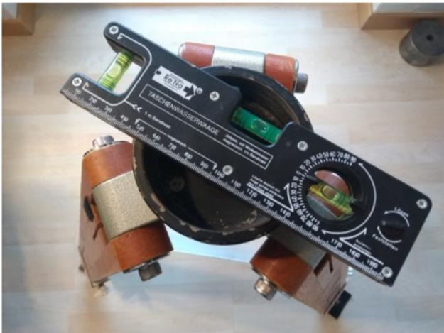
2. Die geogr. Breite (Polhöhe) der Montierung mit der App „Clinometer“ einstellen und darauf achten, dass das Smartphone/Tablet parallel zur Stundenachse aufliegt.
