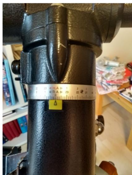
6. Den Teilkreis der Deklinationsachse auf den Wert der geografischen Breite arretieren. Der Deklinationswert des Zenits für einen Beobachtungsort ist gleich der Polhöhe. (Münster: Zenit  $90^\circ$  Höhe =  $52^\circ$  Deklination =  $52^\circ$  Polhöhe)
