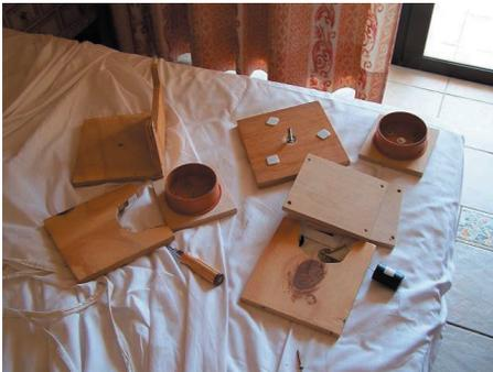
wasserfest verleimten Birkensperrholz wurde die Fernrohrwiege angepasst und verschraubt, als Höhenräder dienen, wie bei meinem 8`` Dobson, Muffenstopfen aus der Abwassertechnik (bei Dobermann erhältlich) die Minirockerbox besteht wiederum aus zusammen-
