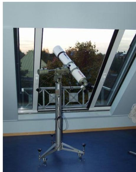
ausschraubbare Standfüße werden auf Extra-Schwingungsdämpfer gestellt, die die Bodenschwingungen weitgehend entkoppeln und ein ruhiges Beobachten ermöglichen.
