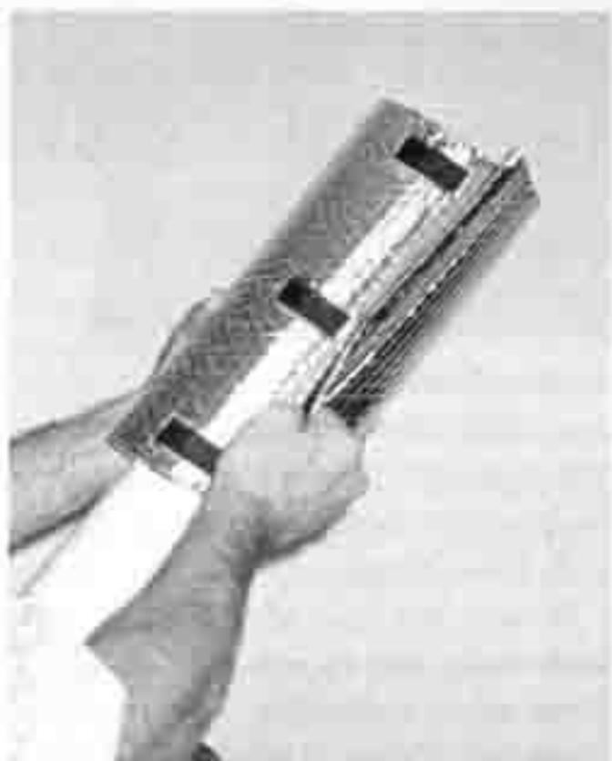
baren oder angenähten Klettverschluss. Das Moosgummi unterbindet recht zuverlässig das Rutschen sowie Lichtreflexe und isoliert zugleich Wärme. Die Taukappe ist leicht genug, dass eine Neubalancierung des Instruments entfällt, und sie lässt sich gut verstauen.
