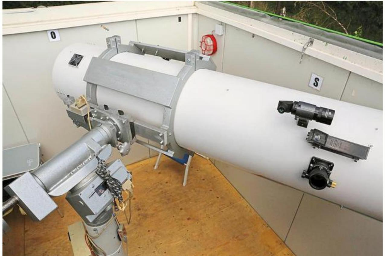
Das Herz der neuen Sternwarte bildet das 40 Zentimeter durchmessende Spiegelteleskop auf seiner 35 Kilogramm schweren Montierung. Es ermöglicht einen eindrucksvollen Blick in die Tiefen des Weltalls.
